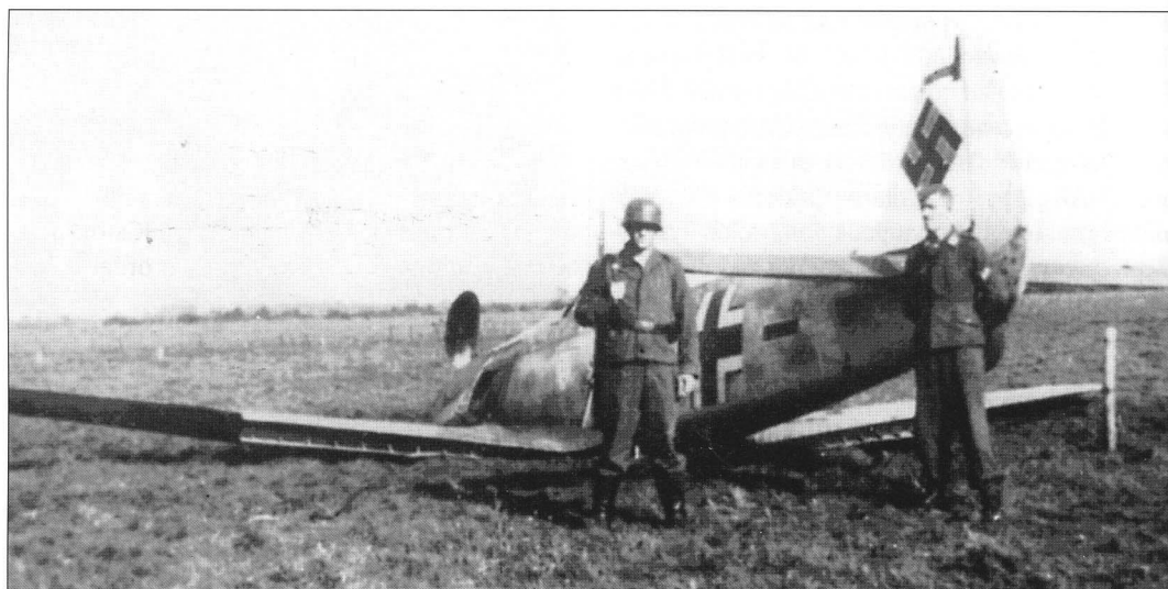
Fw 190A-5 ze Stab/JG 1, który musiał przymusowo wylądować wskutek awarii silnika w pobliżu Donkerbrök dnia 27 września 1943 roku. Statecznik pionowy maszyny pomalowany w całości kolorem białym.
