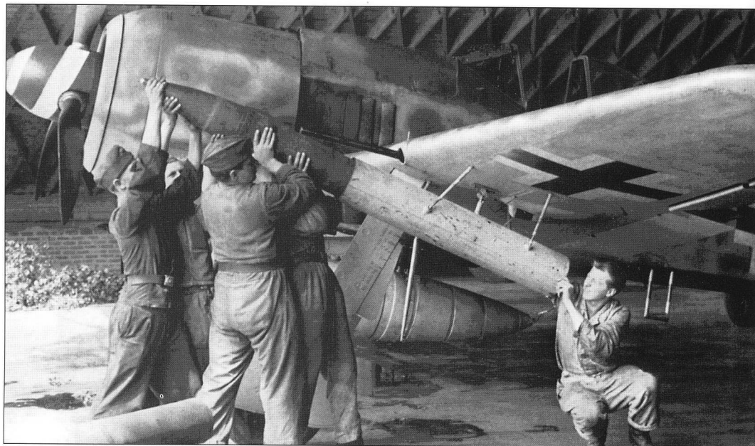
Ładunek niekierowanego pocisku WGr. 21 do rurowej wyrzutni umieszczonej pod skrzydłem samolotu Fw 190A-7/R6. Loading an unguided WGr. 21 missile into a launcher under the wing of an Fw 190A-7/R6.
